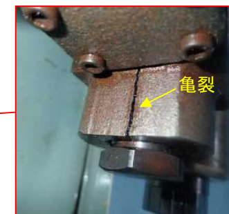
バルブブロック破損状況
