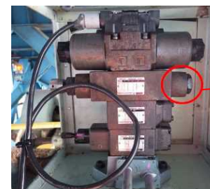
バルブブロック破損状況
