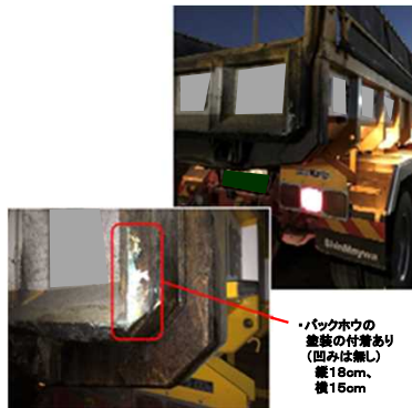
ダンプトラック損傷状況
