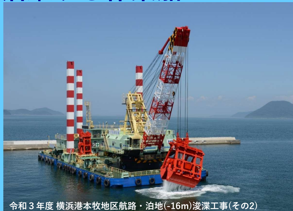
若鷲丸：グラブ浚渫船兼全旋回式起重機船
